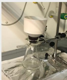
A la masa de cristales añadimos  $H_2O$ , agitamos y filtramos con un sistema a vacío
